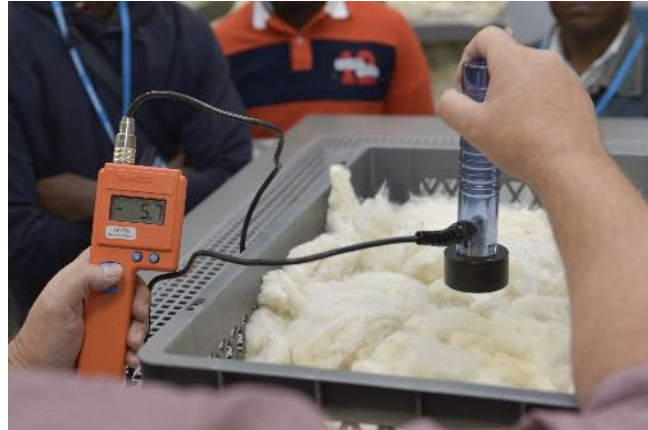
Feuchtigkeitsmessung von Baumwolle im Prüflabor © Foto: Bremer Baumwollbörse
